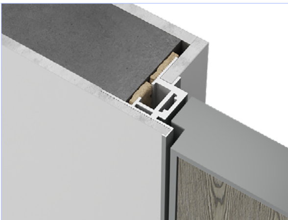
Короб Invisible Reverse Infinity (44) обратное открывание, без верхней перемычки
